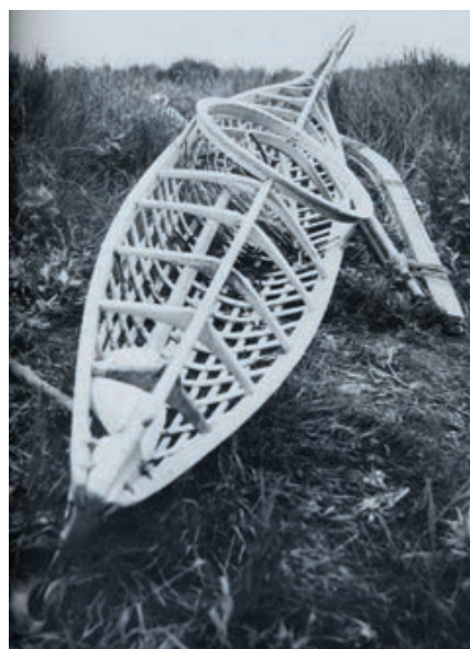
キング・アイランドのカヤックフレーム /サーフゾーンに耐えられる構造になっている。(参考資料 QUJAQ)
